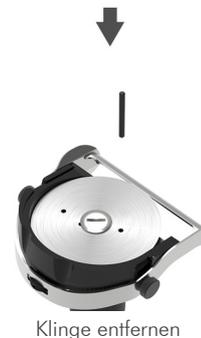
5. Lösen Sie die Haltescheibe durch Drehen entgegen dem Uhrzeigersinn. Hierzu können Sie z. B. eine Münze verwenden.
